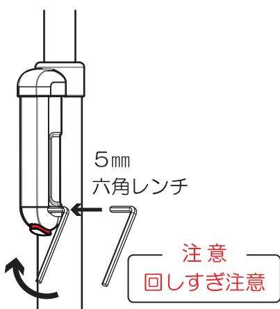
5mmレンチをカバーの穴に差し込み回します。
