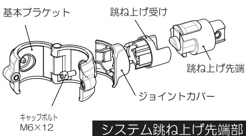
跳ね上げ先端部、跳ね上げ回転部の方向を合わせ手すりに差しこみM6キャップボルトで固定してください。
