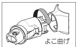
固定ブラケットの方向を合わせ手すりに差し込みM6キャップボルトで固定してください。
