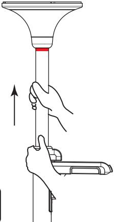
ロックレバーを直角に開き、上部パイプを少し伸ばし、ロックレバーを閉じます。
